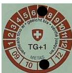
Entspricht ein Messmittel bei der Nacheichung den gesetzlichen Vorschriften, wird es mit einer Eichmarke versehen, welche die Dauer der Gültigkeit der Eichung anzeigt (im Bsp. bis Juli 2011).
